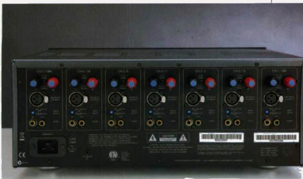
Sul pannello posteriore del P777 sono disponibili per ognuno dei sette canali di amplificazione, oltre ai morsetti per il collegamento dei diffusori, un ingresso bilanciato e una coppia ingresso/uscita per segnale sbilanciato.
